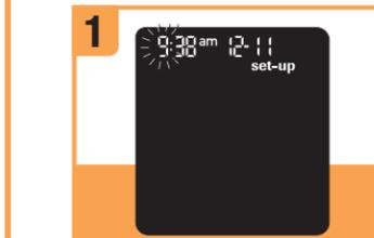
El medidor le indicará que ajuste la hora y la fecha la primera vez que lo encienda. En la pantalla aparece **set-up** con la hora parpadeando.
